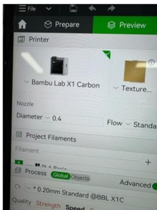
Fig. 16 Configurarea imprimantei (Bambu Lab X1 Carbon, dual hot end, platformă automată) și a materialelor (PLA Basic) în Bambu Studio
