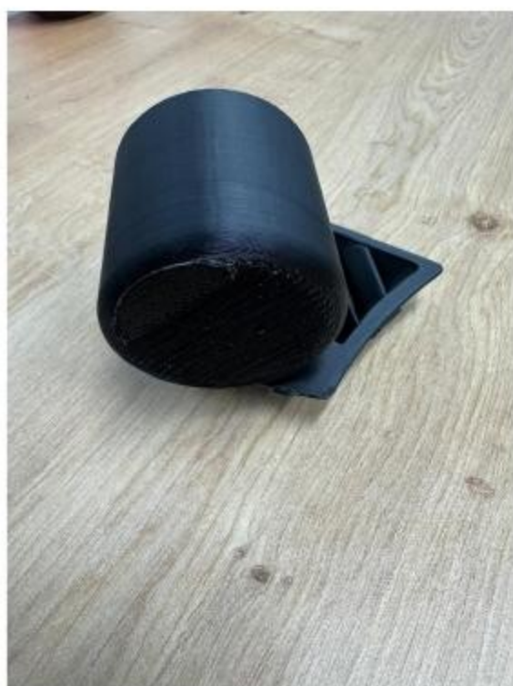
Fig. 33 A serie variabilă a piesei, valoare limită – reprezintă corpul cilindric care compune modelul, cu finis de suprafață uniform pe toată circumferința, inclusiv în zona interioră aferentă de defectul de tip 1
