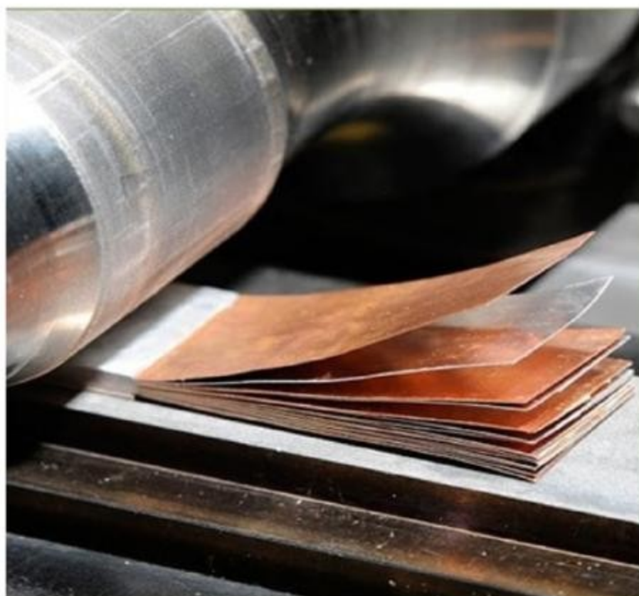
Fig. 2 Procesul de laminare a foliei – LTM (Problema 4p. 15)
