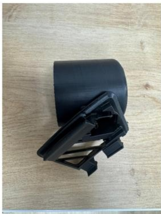
Fig. 29 A serie variată a piesei, unde dintr-un material compozit cilindric – 100% rășină, 0% pulbere
