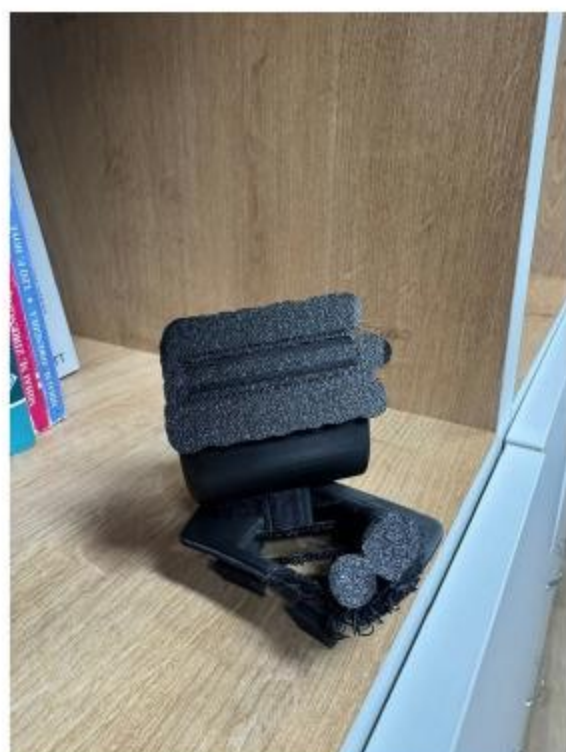
Fig. 25 Proiectare preliminară a dispozitivului, realizare de asamblare, cu suportul de imprimare înalt
