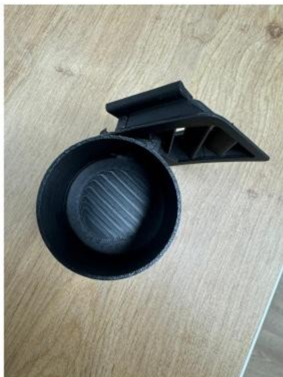
Fig. 28 A serie variată a piesei, unde dintr-un material compozit cilindric – 100% rășină, 0% pulbere
